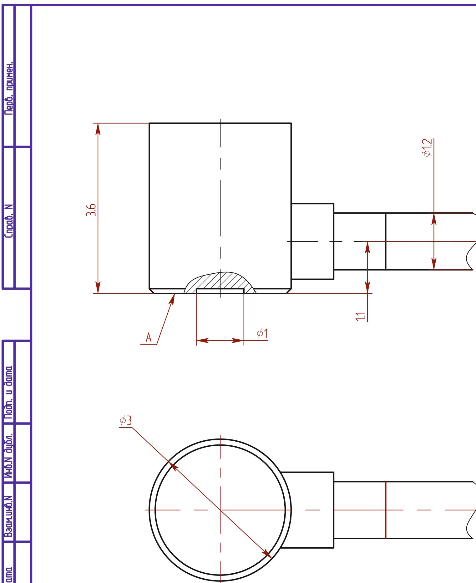
1. Вибропреобразователь AP1019 или AP2019 крепить на объект испытаний поверхностью А с применением клея ВК-9 и склеивание по ОСТ В95 1653-75.
